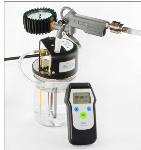
Abbildung 1: Versuchsaufbau mit Gaskalibrator Mark II und Kompressor; im Test der spätere Testsieger Dräger Alcotest 6510.
